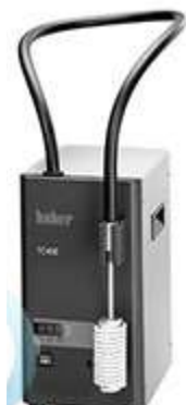
Huber TC45E (-45...100°C, Pt100) — охладитель лабораторный погружной
