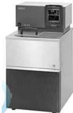
Huber CC-415 (-40...200°C, 5 л) — воздушное охлаждение термостата
